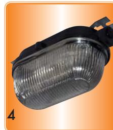
Светильники применяются для освещения влажных, сырых, пыльных, пожароопасных производственных помещений. Обладают высокой степенью защиты от пыли и влаги IP53 и IP65. Корпус изготавливается из карболита. В светильниках могут применяться как обычные лампы накаливания ЛОН, так и компактные люминесцентные лампы КЛЛ. В светильниках установлены керамические патроны с цоколем Е 27. Светильники выпускаются согласно ТУ 3461-005-35936301 в соответствии с ГОСТ Р МЭК 60598-1-2003, ГОСТ Р МЭК 598-2-1-97
