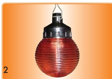
Светильники применяются для освещения объектов проведения ремонтно-строительных работ. Обладают высокой степенью защищенности от пыли и влаги IP-53. Корпус изготавливается из карболита. В светильниках применяются лампы накаливания ЛОН. В светильниках установлены керамические патроны с цоколем Е 27.
