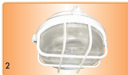
Светильники "Раунд" отличаются удобством обслуживания. Рассеиватель светильника имеет специальные выступы, позволяющие легко снимать стекло, повернув его против часовой стрелки, открыв тем самым доступ к лампе. Светильник имеет высокую степень защиты IP 44. Полипропиленовый корпус позволяет повысить влагостойкость светильника, облегчить его вес.
